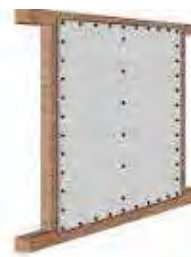
↑構造用合板を釘などで打ち付けたもの
